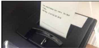
Asegúrese de que el papel esté instalado a través del orificio de la compuerta de la impresora
