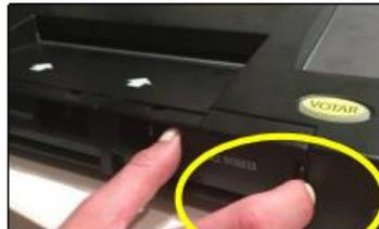
Abra la compuerta presionando suavemente la pestaña en el lado derecho de la compuerta y baje la compuerta
