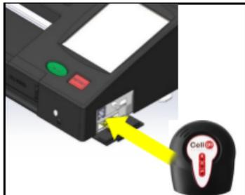
Después de haber impreso el acta de escrutinio de colegio, remueva el sello para abrir la compuerta lateral y conecte el módem utilizando el cable provisto.
