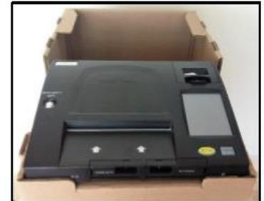
Coloque la máquina en la base y asegúrese que las 3 lengüetas metálicas encajan en las ranuras correspondientes.
