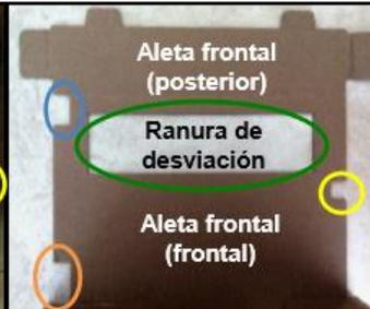
La aleta frontal de la urna tiene 3 ranuras en las cuales las lengüetas metálicas de la máquina deben encajar.
