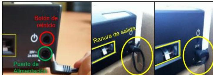
Conecte la parte delgada del cable de tomacorriente en el puerto de la máquina. Deje un par de pulgadas de cable colgando de manera que el cable no quede tenso. Coloque el cable sobrante debajo de la máquina asegurándose de que no obstaculice la ranura de salida manteniendo una conexión firme. El cable de tomacorriente se coloca por el lado izquierdo de la urna.
